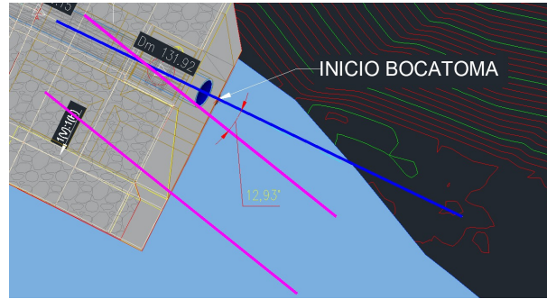
Figura 6-22 – Angulo formado por el eje del cauce y el eje principal de la estructura
